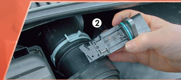
Pulverizar CRC Air Sensor Clean generosamente en las partes del caudalímetro. Dejar secar completamente.
