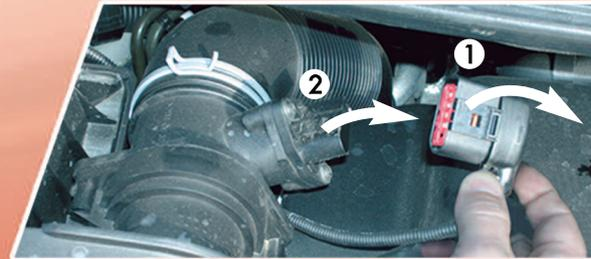
Desmontar cuidadosamente el caudalímetro de la caja.
