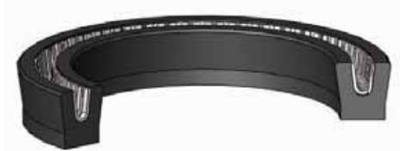
K751 es una junta de pistón de simple efecto compuesta de dos elementos que consiste en un collarín de PTFE con un muelle metálico como elemento energizante.
